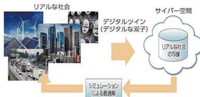
図表4 リアルな社会をデータとしてサイバー空間に再現しデジタルツインとして相互の融合を図る
