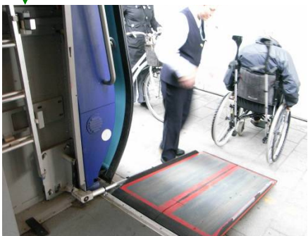
電車から降りる車いす使用者：スロープは電車の扉付近（写真左側）に格納されている
