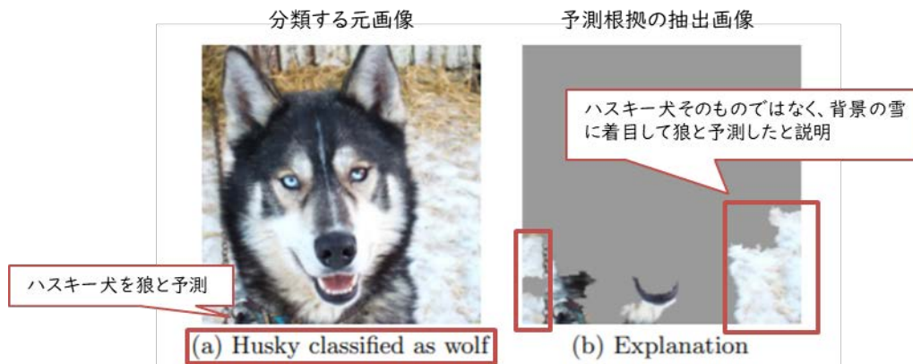
図表 4 ハスキー犬を狼と誤って予測した予測根拠の説明イメージ
